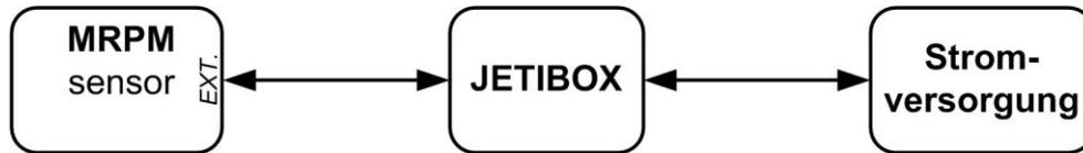
2. Schließen Sie das dreiadrige Kabel des Moduls MRPM mit dem JR-Stecker an der Rückseite des DUPLEX-Empfängers an (an den mit Ext. bezeichneten Anschluss). Das MRPM-Modul wird vom Empfänger mit Strom versorgt. Zur Einstellung der Parameter des MRPM-Moduls schließen Sie die JETIBOX an das Sendermodul an und schalten Sie DUPLEX-Empfänger und -Sender ein
