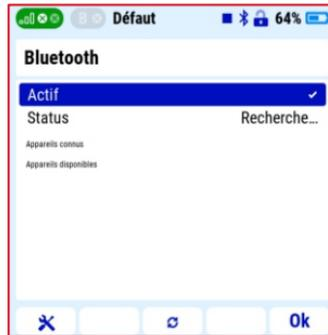
ci. Le module prend en charge le profil A2DP avec le codec SBC pour la transmission audio. Pour la fonction audio sans fil, vous devez d'abord activer le Bluetooth depuis l'émetteur et ensuite associer les enceintes ou les écouteurs sans fil selon la procédure suivante :
