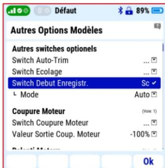
**Note:** Un paramètre approprié serait, par exemple, de choisir le mode „Auto“. Dans ce mode, l'enregistrement de la télémétrie démarre simultanément avec tous les chronos en marche (tels que le temps de vol du modèle, etc...).
