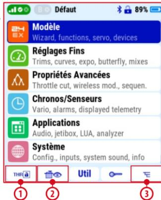
2. l'icône avec un symbole en forme de servo et d'œil (touche **„F2”**) ouvre la fonction du moniteur de servo.
