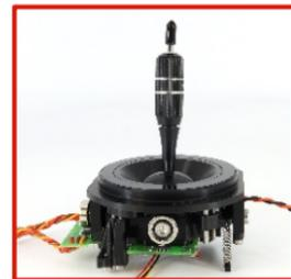
**Attention:** Après l'installation du manche avec interrupteur/bouton, il n'est plus possible de régler la hauteur du manche sauf à desserrer la vis de verrouillage, au risque de voir les câbles se tordre.
