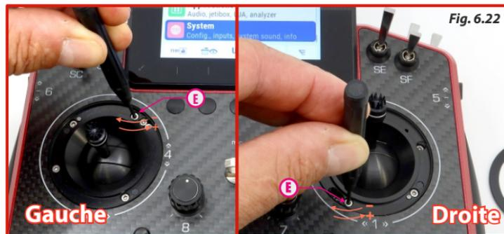
**Note:** Lorsque la vis est complètement desserrée, la tête de la vis (a) ne doit pas dépasser de la surface de l'anneau de protection (b) (Fig. 6.15).
