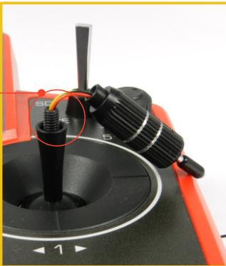
**3. CZ** - Vodiče páky s přepínačem/tlačítkem postupně prostrčte otvorem páky křížového ovladače.
