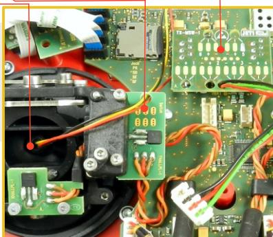
ovládače mít dostatečnou rezervu, aby se nedotýkaly pohyblivých části a nebyly namáhané ohybem.
