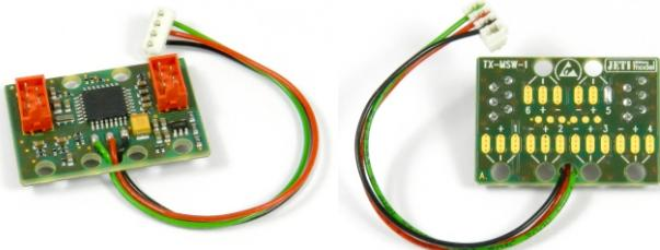
**CZ** - je určen pro vysílače DC/DS. Tento modul umožňuje připojit až šest nezávislých ovládacích prvků jako jsou přepínače nebo potenciometry. Modu TX-MSW se instaluje přímo do vysílače na hlavní DPS a jeho výstup se připojí na interní PPM konektor.
